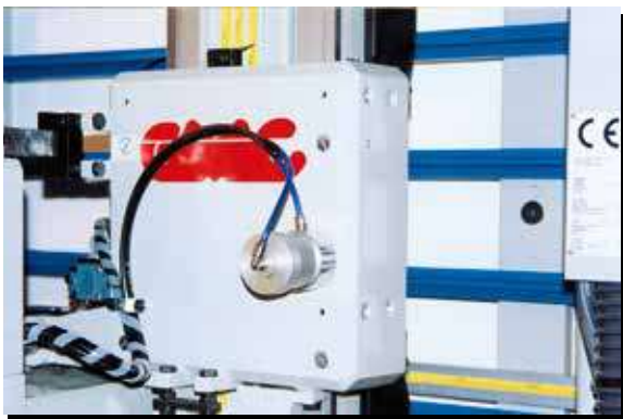
Bloccaggio pneumatico carrello sega Pneumatic locking of the saw-carriage
